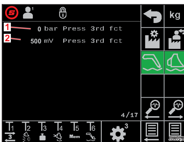
Abb. 40 Drucksensor im 3. Steuerkreis
