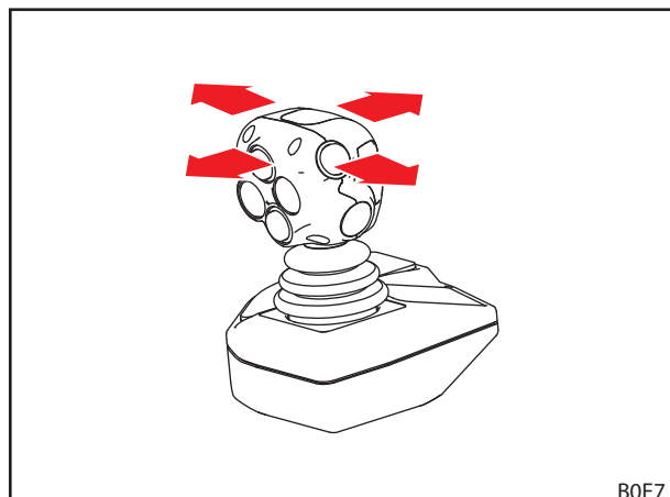
Σχ. 67 Μετακίνηση Joystick σε όλες τις θέσεις τερματισμού
